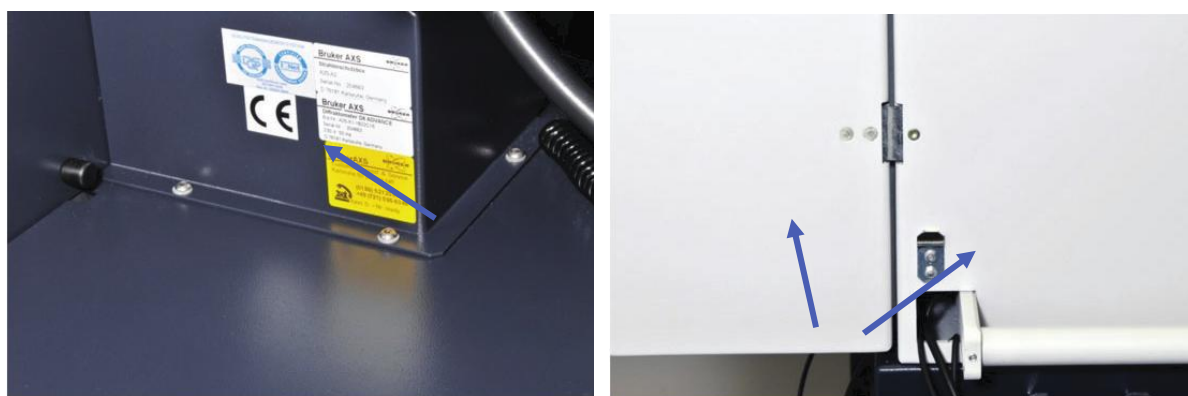
Рисунок 2 – Защита спектрометров рентгенофлуоресцентных S8 TIGER от несанкционированного доступа.
