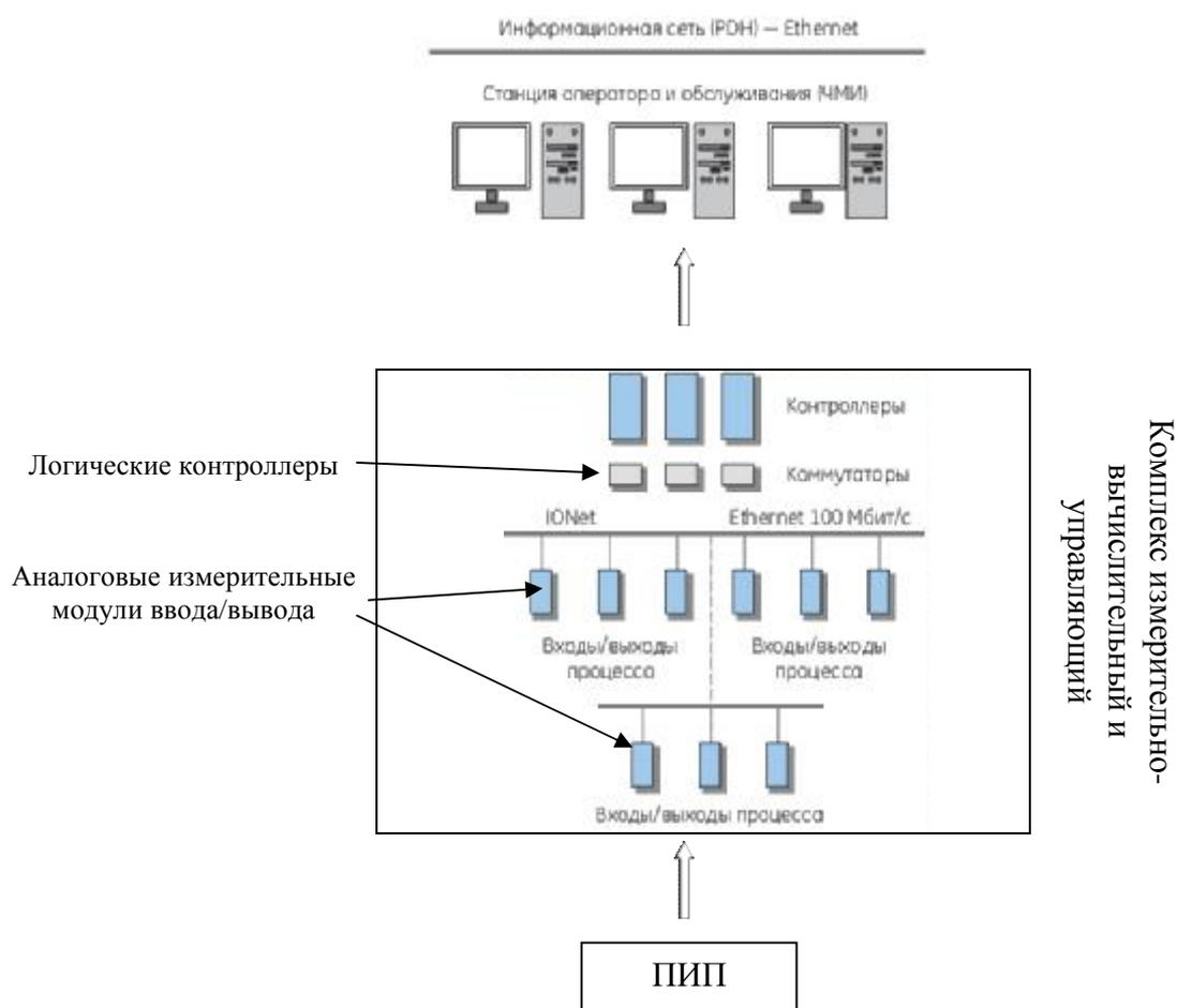
Рисунок 1 – Схема архитектуры комплексов измерительно-вычислительных и управляющих.
