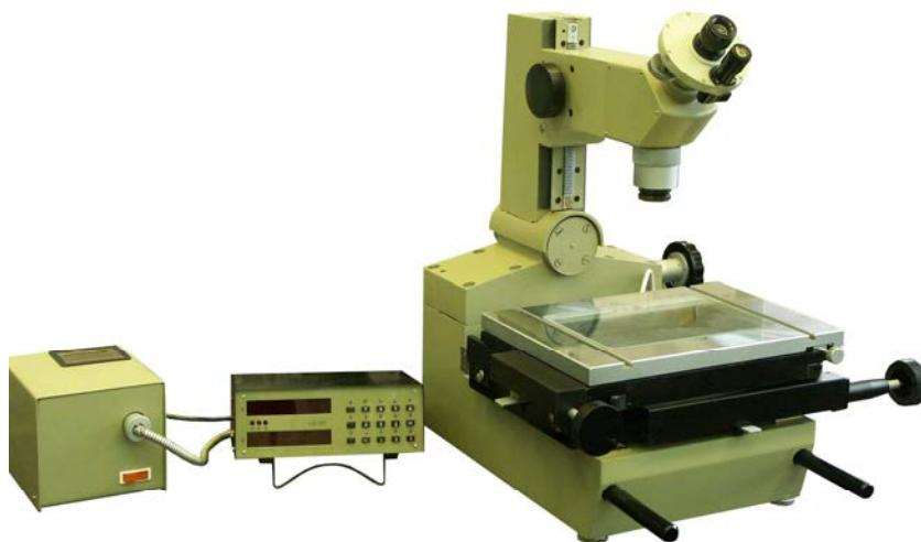
Рисунок 1 – Микроскоп инструментальный ИМЦЛ 150х75(2),Б
