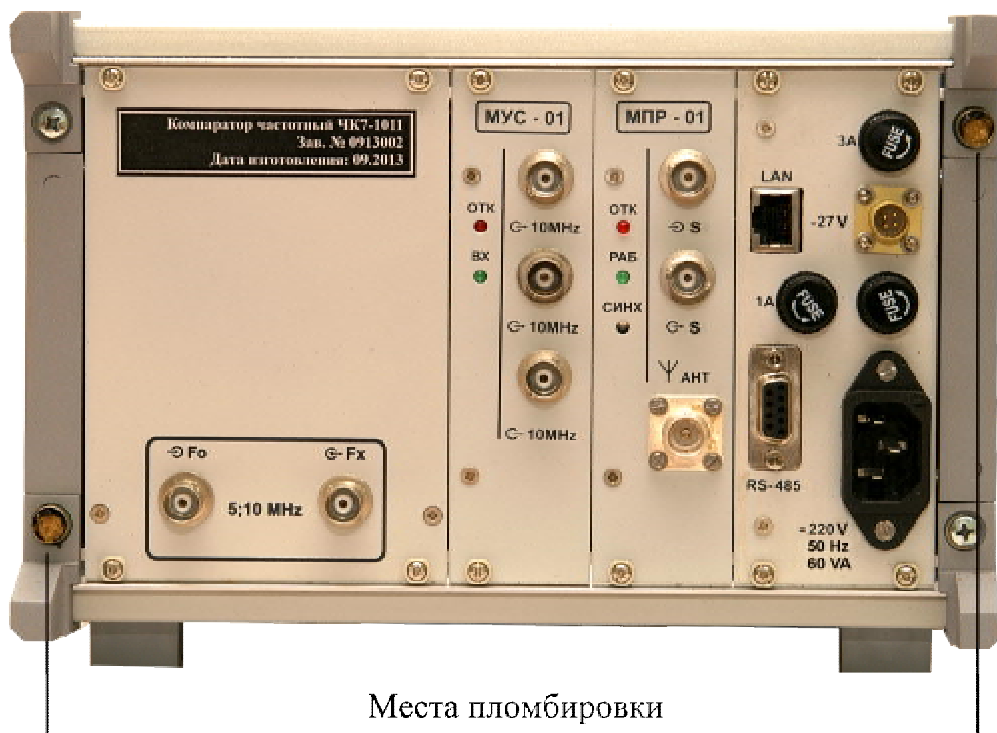
Рисунок 2 – Схема пломбировки от несанкционированного доступа.
