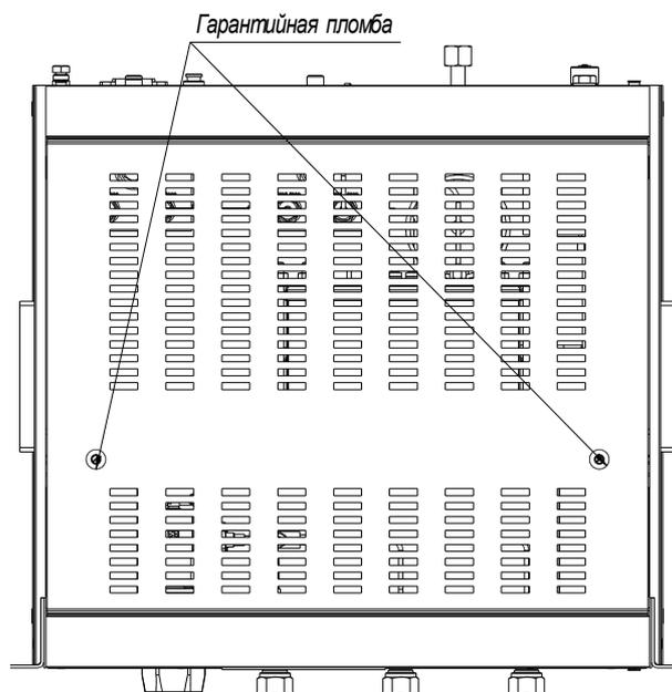
Рисунок 2 - Схема пломбировки генераторов от несанкционированного доступа и обозначение мест для нанесения оттисков клейм.
