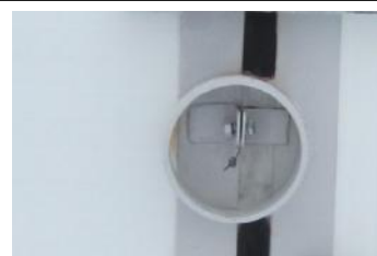
Рисунок 1-схема пломбирования корпуса контроллера БИОИ
