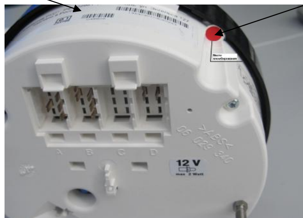
Рис.2 Место пломбирования спидометра электронного 1323
