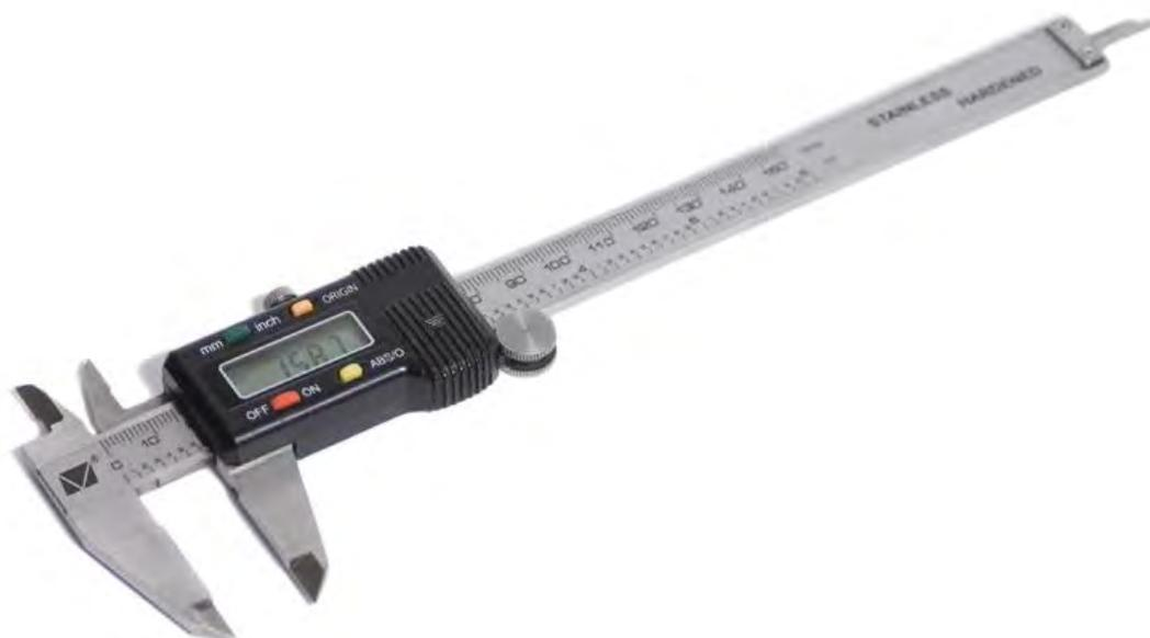
Рисунок 7 - Штангенциркуль с цифровым отсчетным устройством четырехкнопочный ШЦЦ-I
