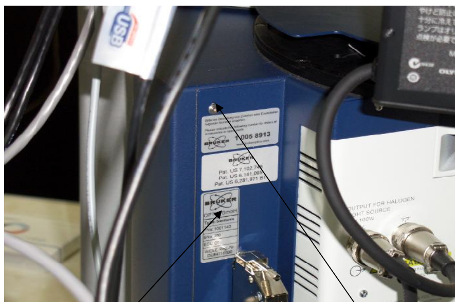
1 2 Рисунок 2 - Спектрометр Senterra - вид сзади 1 - маркировка; 2- место нанесения пломбирования;
