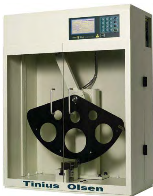
Рисунок 1 – Общий вид копра IT 503
