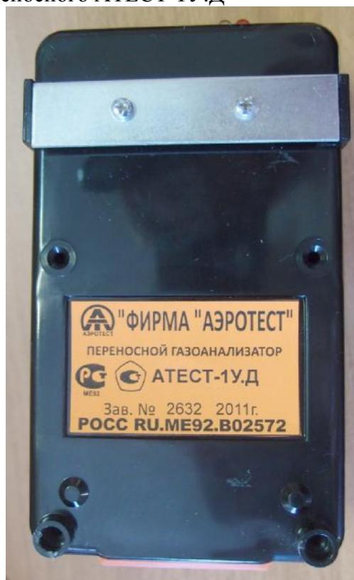
Рисунок 4. Задняя крышка газоанализатора переносного АТЕСТ-1У.Д
