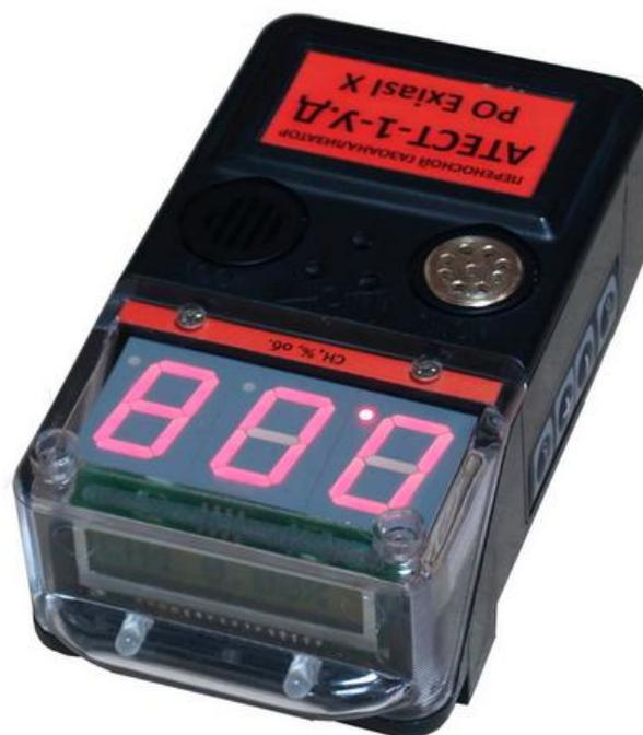
Рисунок 2. Внешний вид газоанализатора переносного АТЕСТ-1У.Д
