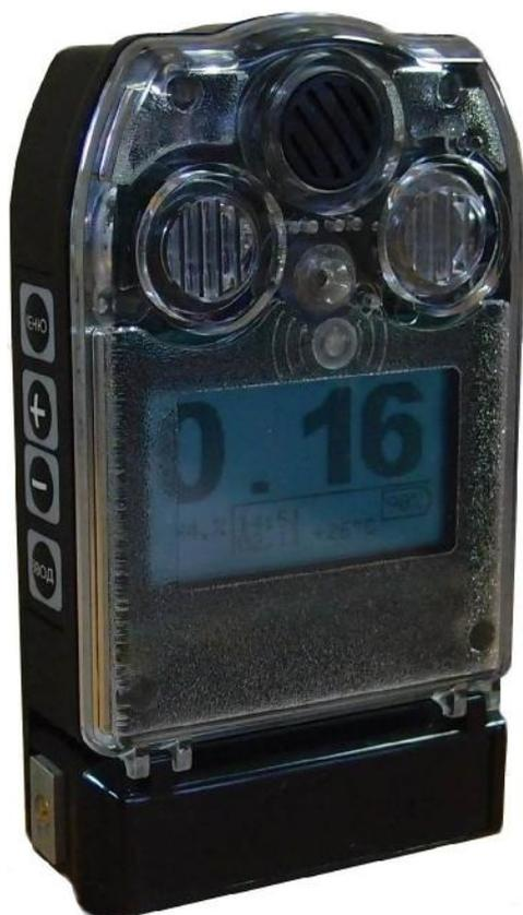
Рисунок 1. Внешний вид газоанализатора переносного АТЕСТ-1
