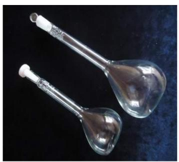
Колбы 1, 2, 2a исполнения представляют собой шарообразный сосуд с плоским или незначительно вогнутым дном и длинным цилиндрическим горлом под шлиф. Колбы с конусами горловин KIII 10/19, KIII 14/23, KIII 19/26, KIII 24/29, могут изготовляться с пробками из пластмассы. На цилиндрической части горловины колб наносится круговая делительная отметка. соответствующая номинальной вместимости колб при температуре 20°C. Колбы вымеряются на наливной объем.
