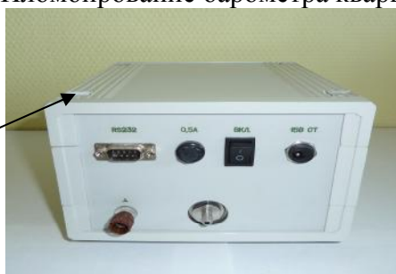
Рисунок 6 – Пломбирование барометра кварцевого МД-20-1
