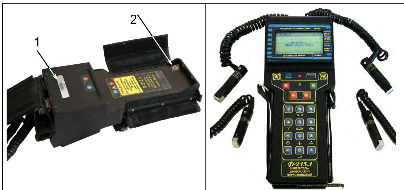
Фото 1 - Общий вид измерителя-дефектоскопа феррозондового Ф-215.1
