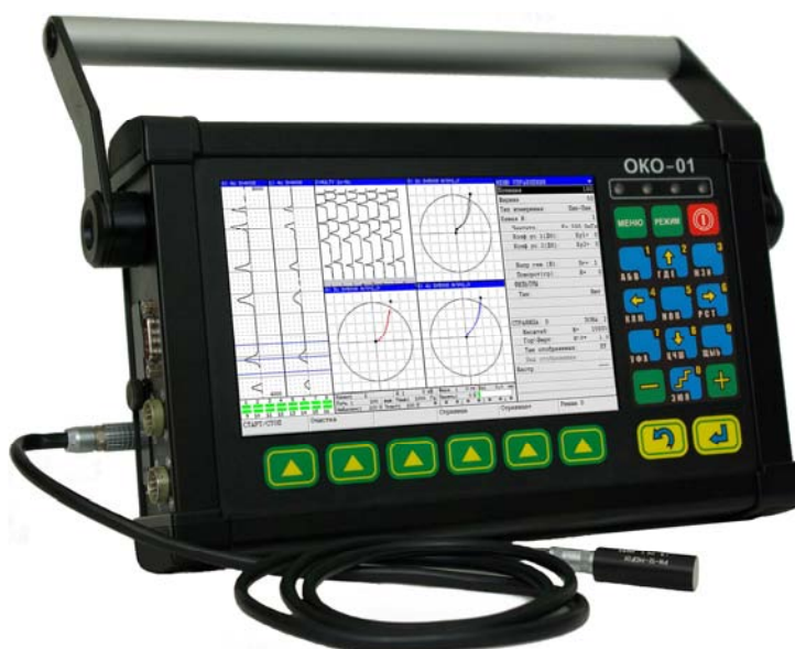
Рисунок 1 - Общий вид дефектоскопа вихретокового многоканального ВД-132-К-ШУ-ОКО-01
