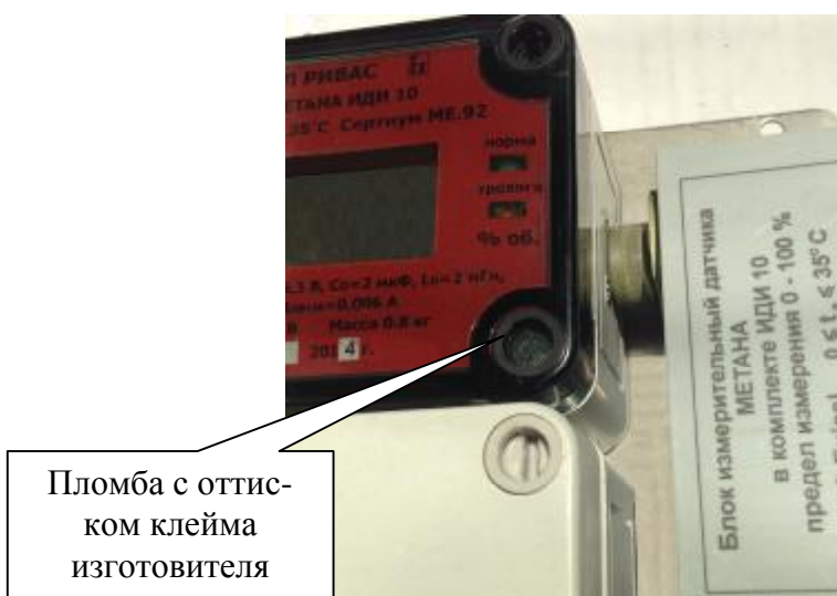
Рисунок 2 – Схема пломбировки от несанкционированного доступа
