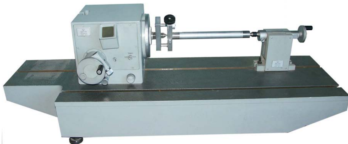
Рисунок 3 – Головка делительная оптическая ОДГ-20
