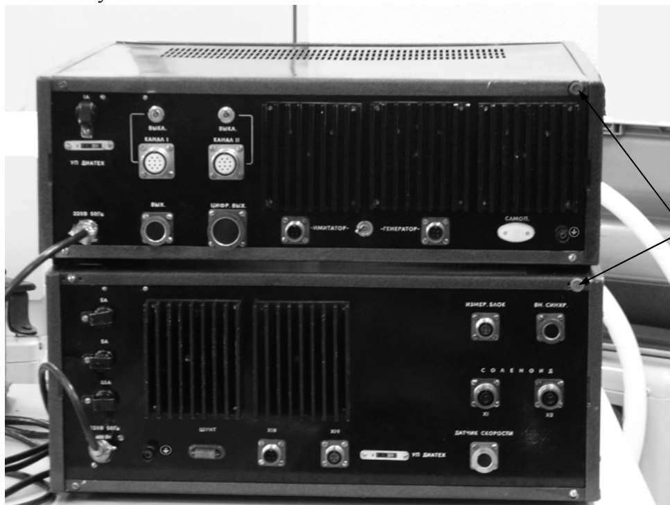
Рисунок 2 - Схема установки пломб от несанкционированного доступа
