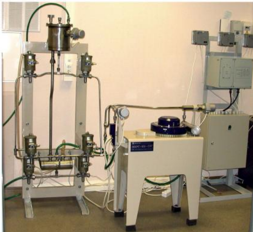
Рис. 1. Фотография общего вида монитора спектрометрического МАРС-012-СУГ
