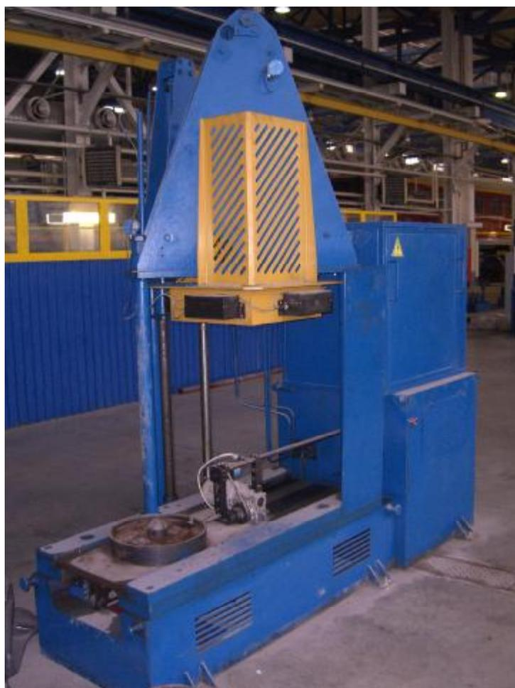
Рисунок 1 – Общий вид стенов автоматизированных для измерения и испытания параметров пружин пассажирских вагонов «Стрела-М1»
