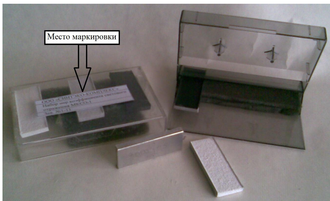
Рисунок 1 – Внешний (общий) вид наборов мер светового коэффициента отражения МСКО-1
