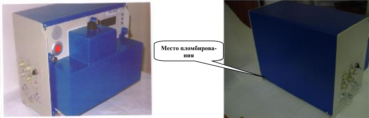
Рисунок 1 – Внешний вид установки для измерения объёмной активности радиоактивных аэрозолей УДА-1АБ
