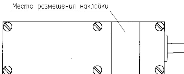
Рисунок 9 - Схема пломбировки преобразователя ваттметров М3-104, М3-105, М3-106
