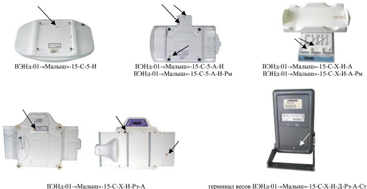
Рисунок 2 - Схема пломбировки от несанкционированного доступа.
