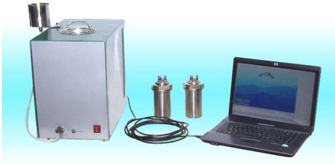
Рис.1. Внешний вид калориметра сжигания с бомбой (жидкостного) В-08МА «К»
