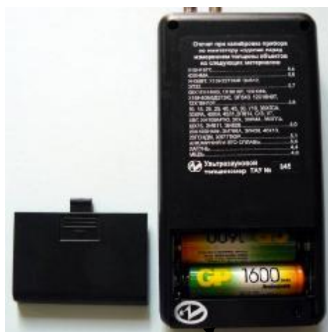
Рисунок 2 - Пломбировка толщинометров ТАУ
