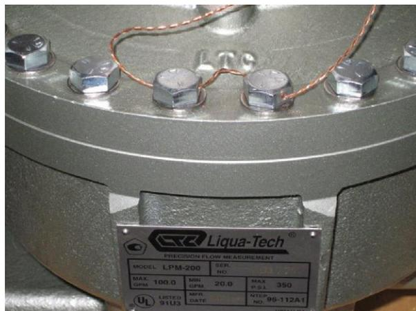
Фото 1.6 – Пломбировка измерительной камеры счетчика модификации LPM-200
