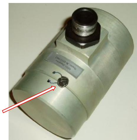
Рисунок 6 – Места пломбировки первичных преобразователей ОП-2\40\100-Э, Т
