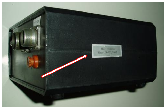
Рисунок 5 – Место пломбировки электронного прибора МС-75
