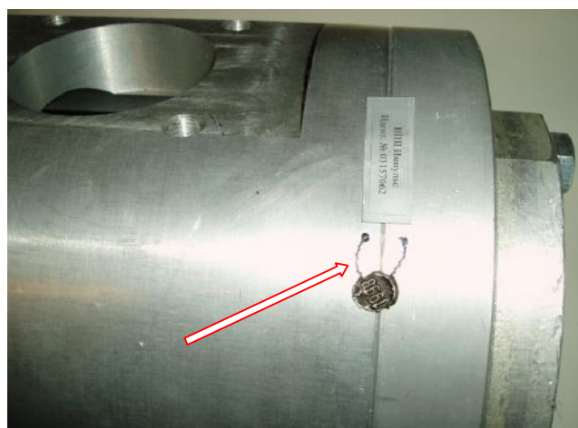
Рисунок 7 – Места пломбировки первичных преобразователей ОП-400\1000-Э, Т
