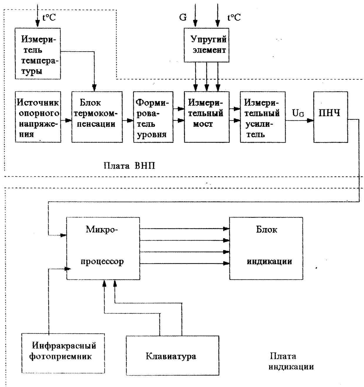
Рисунок 1 - Структурная схема весов крановых
