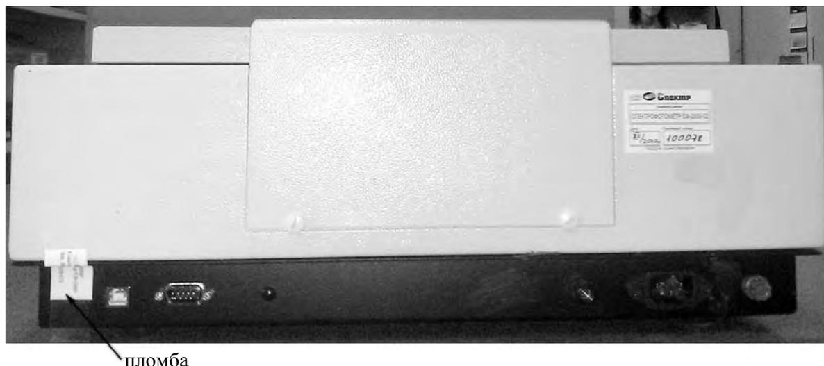
Рисунок 2 – Место пломбировки
