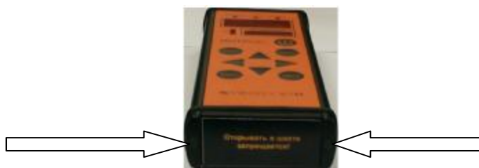
Рисунок 3. Места нанесения пломбировки в измерителе износа стальных канатов (дефектоскопе) ИНТРОС (вид с торца).
