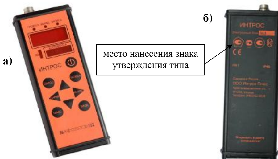
Рисунок 1 - Общий вид электронного блока (ЭБ) и место нанесения знака утверждения типа. а) - лицевая сторона ЭБ, б) - обратная сторона ЭБ
