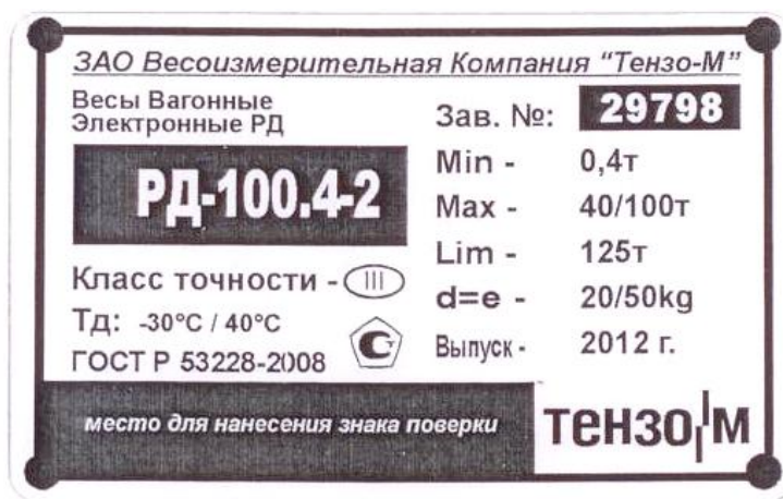
Рисунок 4 – Место нанесения знака поверки в виде наклейки.
