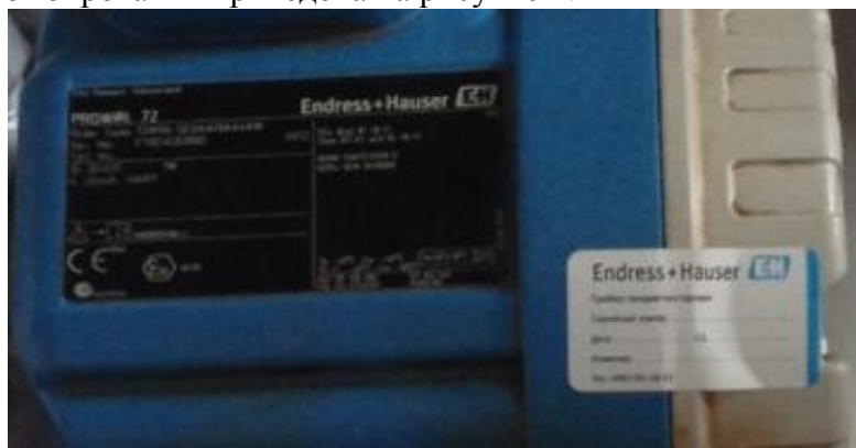
Рисунок 2. Пломбирование корпуса измерительного преобразователя. Программное обеспечение
